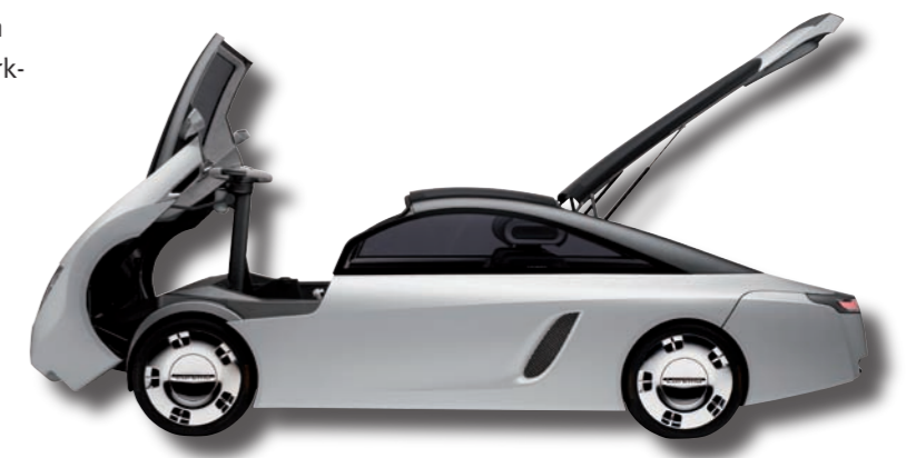
Loremo LS (2009). Hocheffizientes Leichtbaufahrzeug („low resistance mobile“): 2-Zylinder-Turbodiesel, Leistung: 15 kW, Gewicht: 550 kg, 4 Plätze, Höchstgeschwindigkeit: 160 km/h, Verbrauch: unter 2 l / 100 km.
